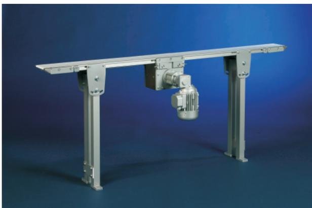
Für längere Ausführungen ist das Förderband mit der entsprechenden Anzahl an Aluminium-Doppelständern ausgerüstet.
