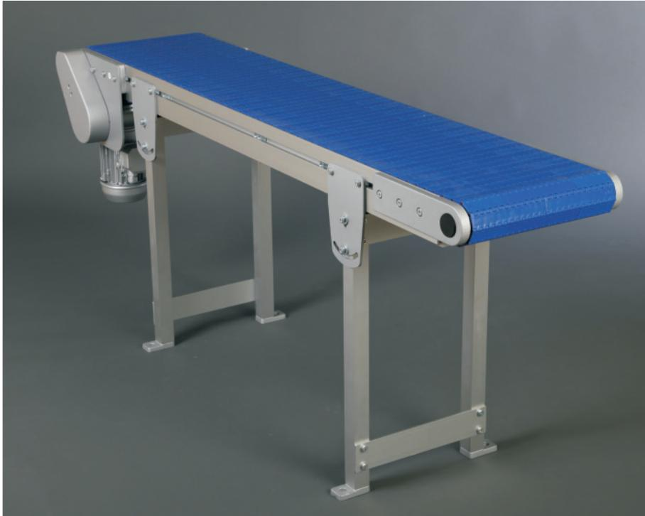
Das Kunststoffmodulband AM-F zeichnet sich durch sein schlankes Design aus. So beträgt die Breite des Rahmens nur 14 mm mehr als die der Kette. An der Umlenkung sind es auch nur 40 mm mehr. Der Rahmen inklusive der Kette ist 95 mm hoch.
