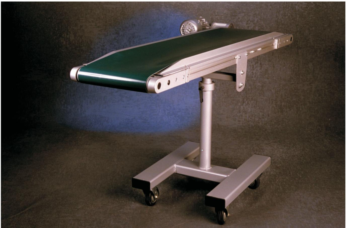
Das GAL-60-M hat einen extrem verwindungssteifen TorsioDur-Rahmen. An den Seiten des Rahmens befinden sich Profilmuten, in denen M-8-Nutsteine zur Befestigung von Zubehör eingelegt sind. So lässt sich das GAL-60-M flexibel an unterschiedliche Einsatzfälle anpassen.
