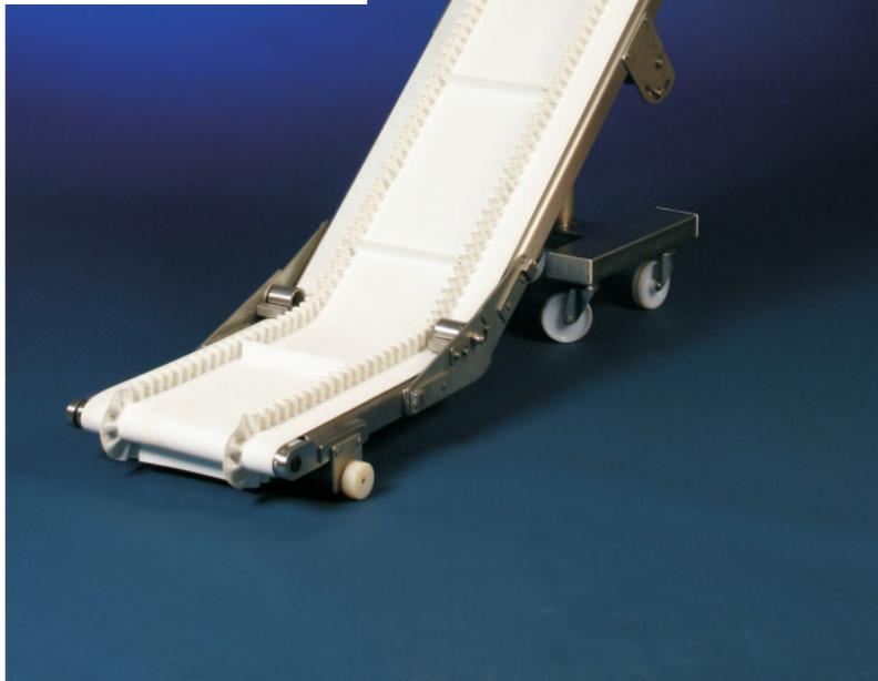
Das GES-50-Z-W hat einen Rahmen aus einem völlig geschlossenen Edelstahl-Profil. Dadurch erfüllt es allerhöchste hygienische Anforderungen. Die Spannvorrichtung an der Umlenk- und Antriebswalze ist in der patentierten CleanTec-Bauweise ausgeführt.
