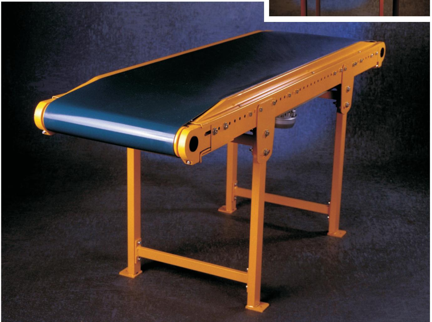
Der Rahmen des GF-80-M ist aus 80 mm hohen Stahlprofilen aufgebaut, die mit 9 mm großen Löchern im Abstand von 30 mm versehen sind. An diesen Löchern lassen sich mit M-8-Schrauben Zubehör und Anbauteile befestigen. So lässt sich das GF-80-M in einfacher Weise an unterschiedliche Einsatzfälle anpassen.
