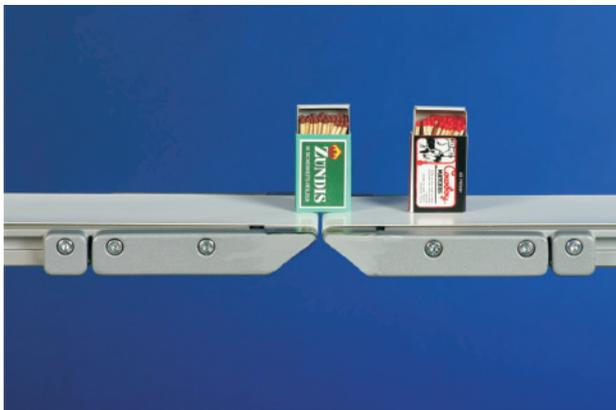
Er ist so verwindungssteif, dass der flexible einlagige Gurt des Förderbandes gleichmäßig geradeaus läuft.
