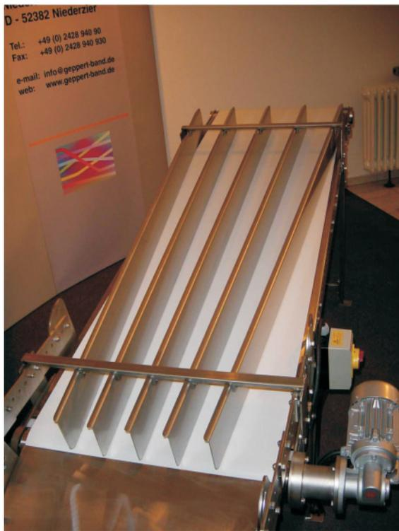
Das komplette Förderband wurde aus Edelstahl gefertigt und mit einem weißen Gurt mit FDA-Zulassung für Lebensmittelanwendungen ausgerüstet.
