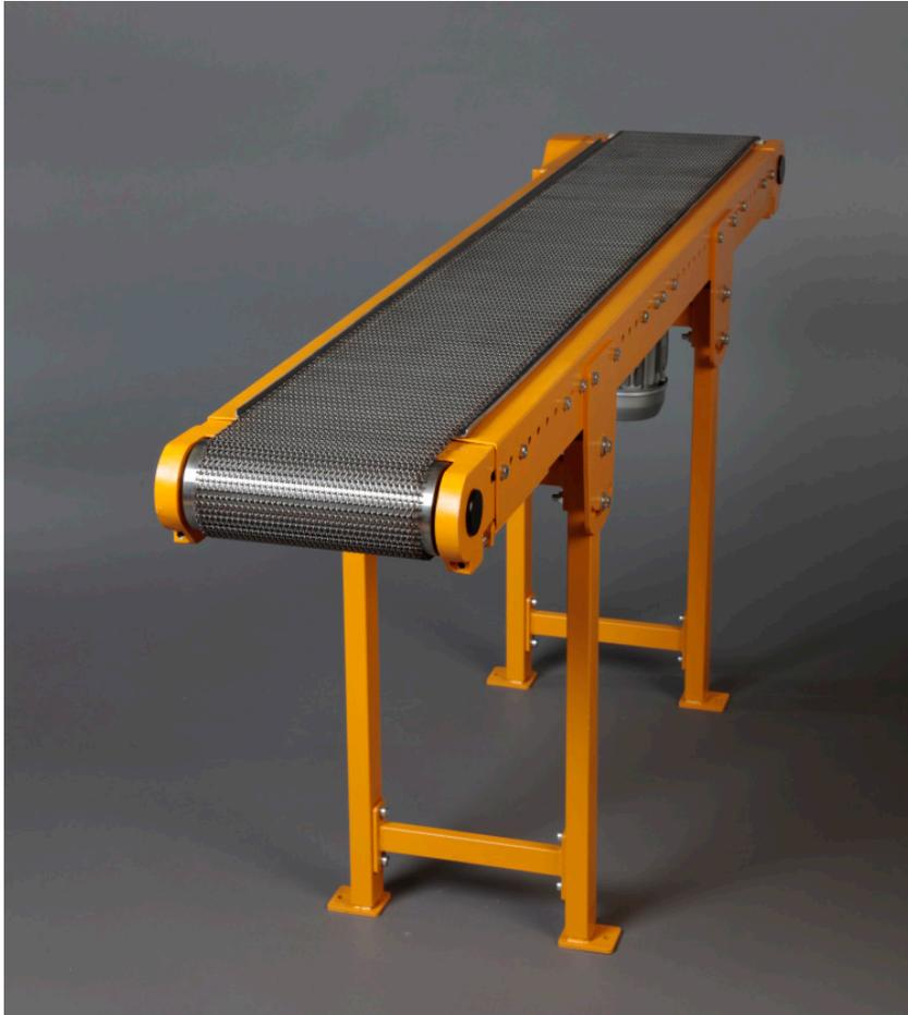
Das Flachförderband GF-80-RDG ist mit einem Runddraht-Gliedergurt ausgerüstet. Er eignet sich besonders für den Transport von sehr heißen Teilen. Durch seine mechanische Belastbarkeit ist er auch eine gute Alternative bei scharfkantigen Metallteilen.
