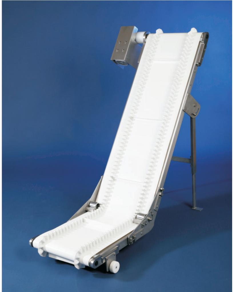
Der Anstiegswinkel des GES-50-K-W ist vom Boden aus zwischen 40 und 60° stufenlos einstellbar. Die Länge des waagerechten und des steigenden Teiles kann an den jeweiligen Einsatzfall angepasst werden. Insgesamt soll eine Länge von 4 Metern jedoch nicht überschritten werden.
