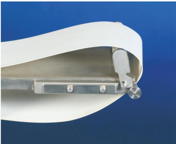
Das Edelstahl-Flachförderband GES-25 ist überall dort optimal geeignet, wo wenig Platz vorhanden ist. Mit seiner Rahmenhöhe von 25 mm und der extrem kleinen Umlenkwalze von 30 mm Durchmesser ist es für die Beförderung von Kleinteilen bestens geeignet. Es lässt sich bestens in bestehende Produktionsprozesse integrieren.
