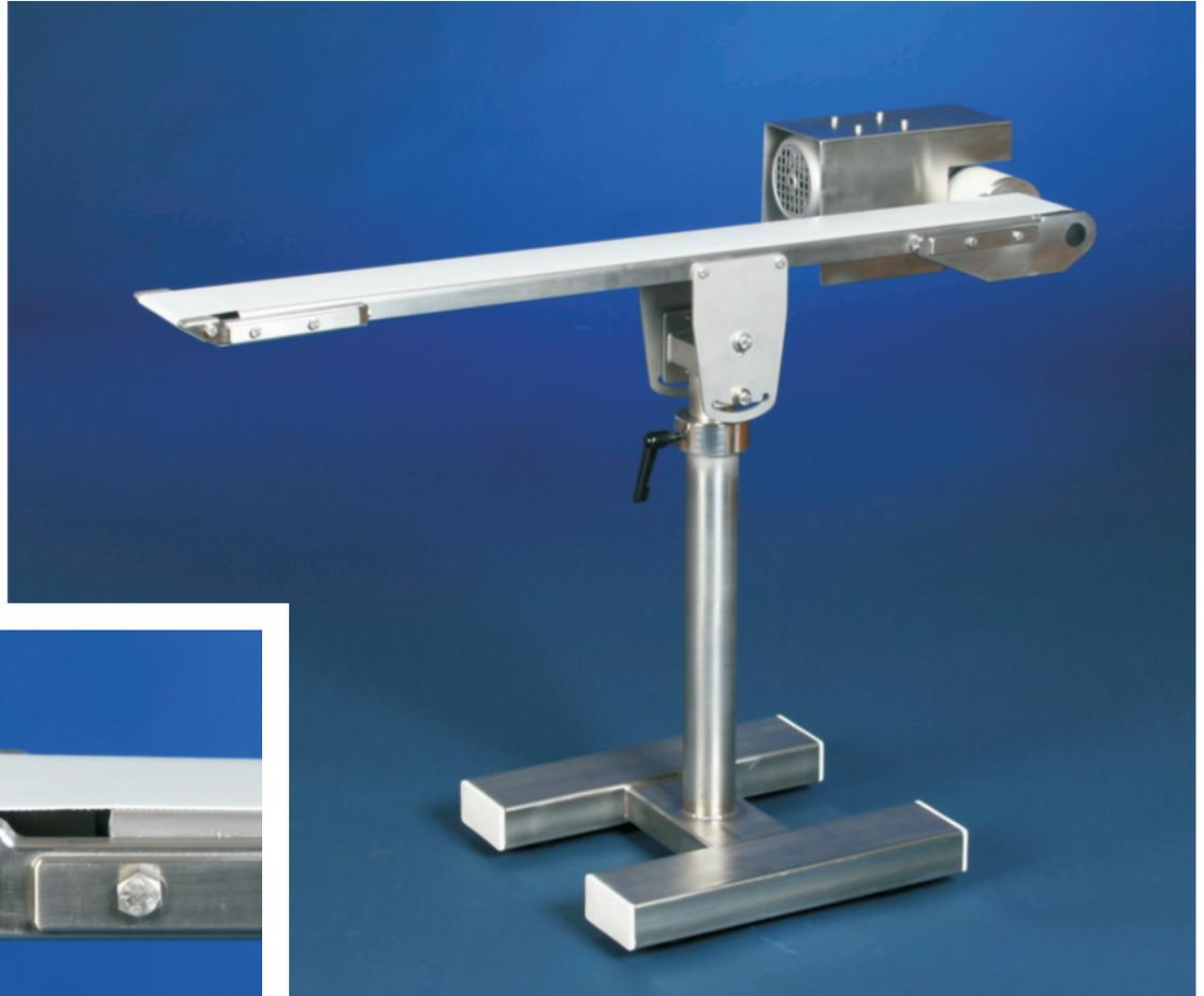
Mit dem Edelstahl-Messerkanten-Förderband GES-25-RMK wird der Transport von Kleinstteilen optimiert. Aufgrund des geringen Durchmessers der Umlenkrolle von nur 8 mm kann haarscharf übergeben oder übernommen werden. Die rollende Messerkante sorgt zusätzlich für eine sanfte Übergabe, denn das Stückgut wird lagerichtig weiter transportiert.
