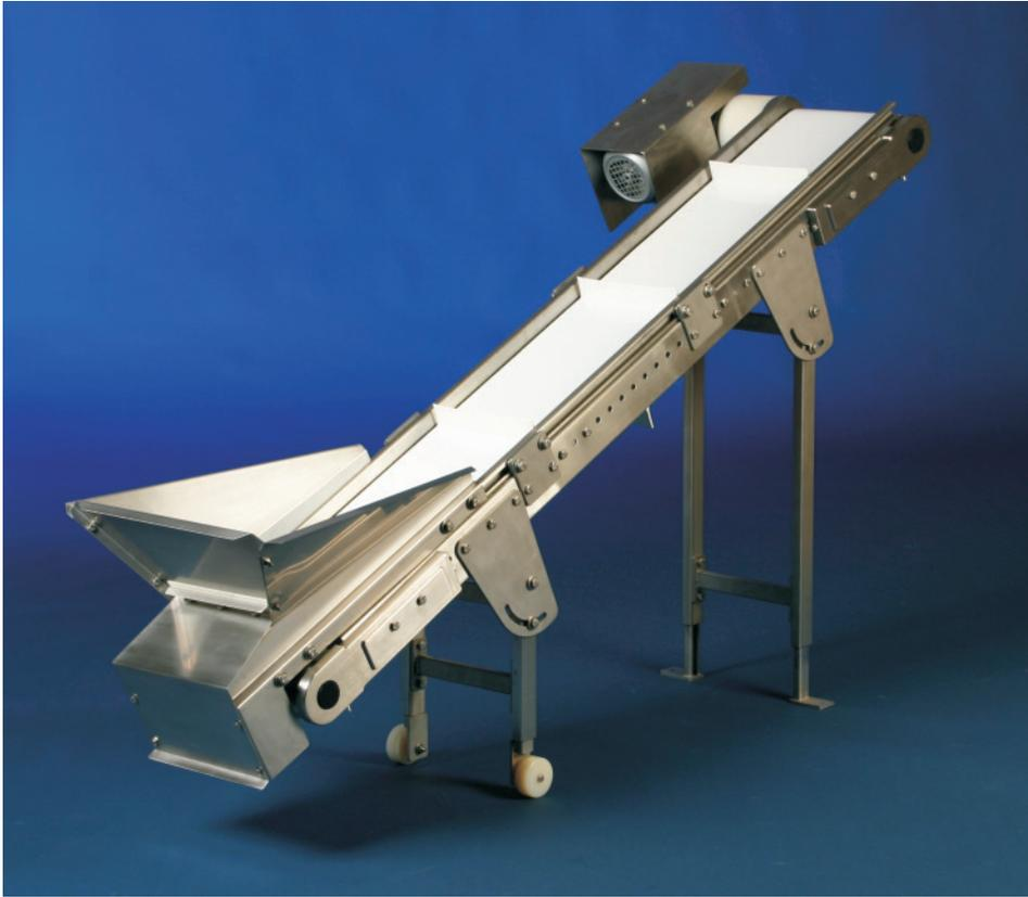
Das Edelstahl-Steigförderband GKES-80 ist mit einem Standardtrichter für die Aufnahme der zu befördernden Teile und mit Querstollen und Seitenführungen ausgerüstet. So können Stückgüter und Schüttgüter problemlos auf die gewünschte Höhe transportiert werden.
