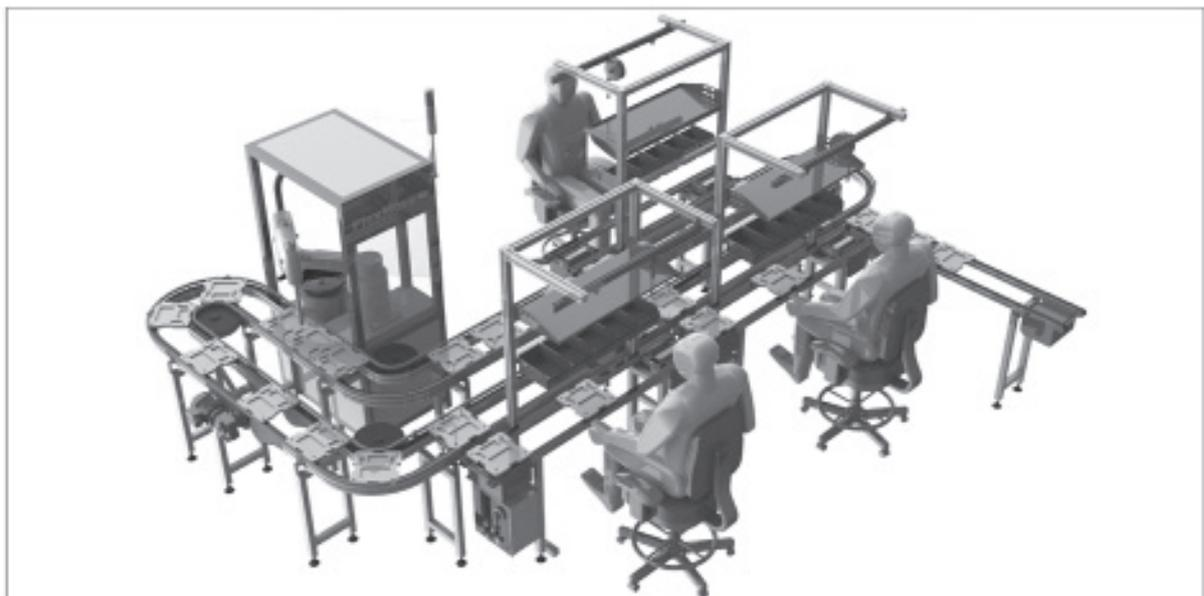
Die **FK-Serie** besteht aus kompakten und übersichtlichen Anlagen für kleine Förderstücke und einen schnellen Transport. Sie kommt auch als zweibahniges System für Palettenmontagelinien zum Einsatz.
